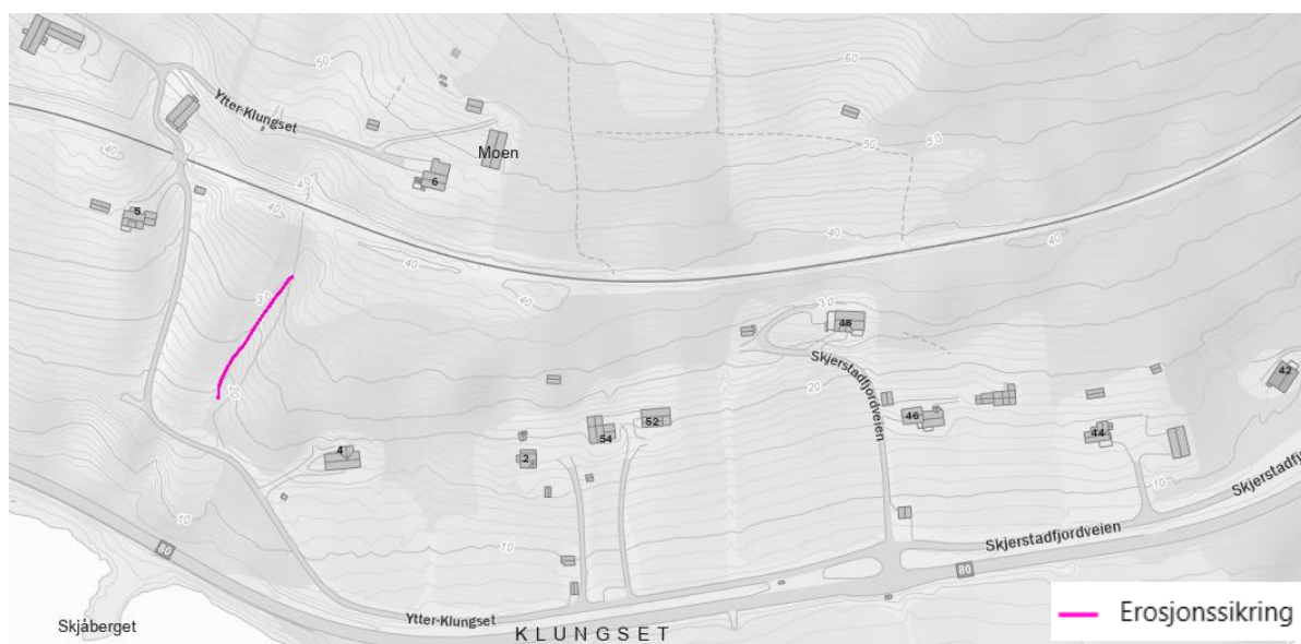
Figur 18: Rosa linje viser om lag 70 meter med erosjonssikring av bekk ved Ytre Klungset. Kilde: NVE atlas.
