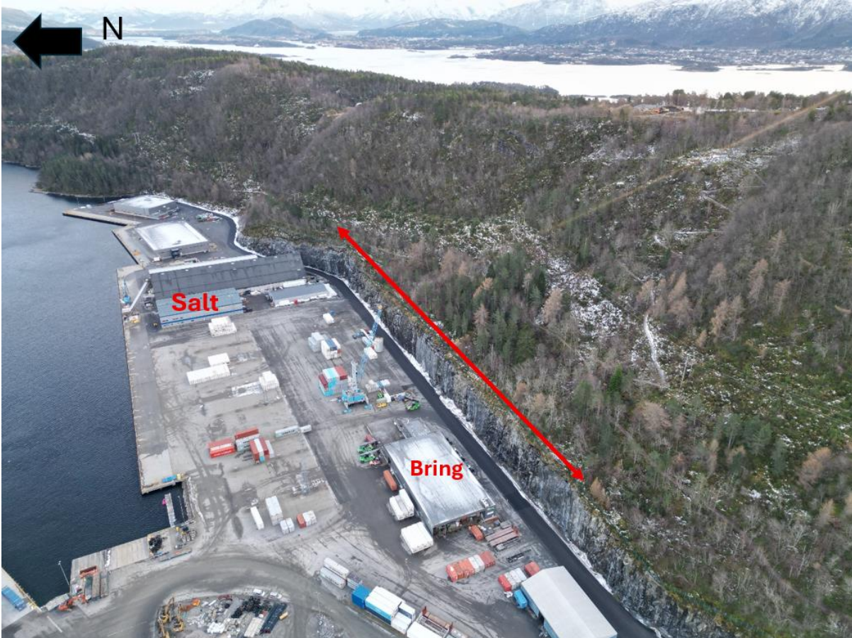
Foto 1 Oversiktsfoto med plassering av saltlager og Bring. Rød pil viser planlagt påhuggsområde for å etablere fjellhaller (Multiconsult)
