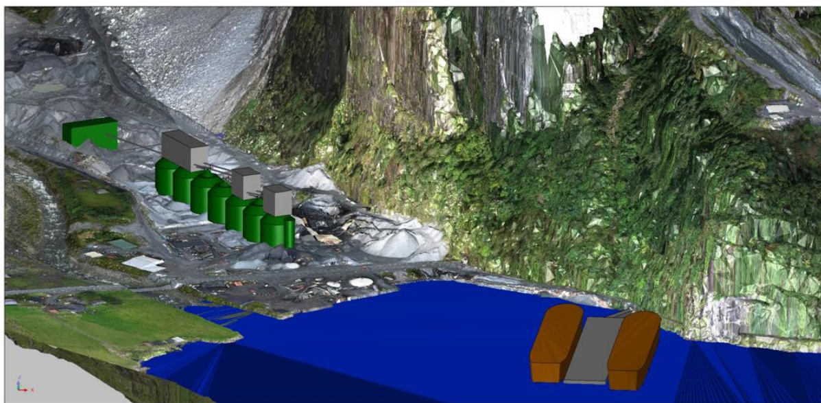
Figur 4-2 Knuseanlegg, silo og lasteanlegg. Fargane er føljebels, dei vert endra. Kjelde: Eikefet Minerals AS
