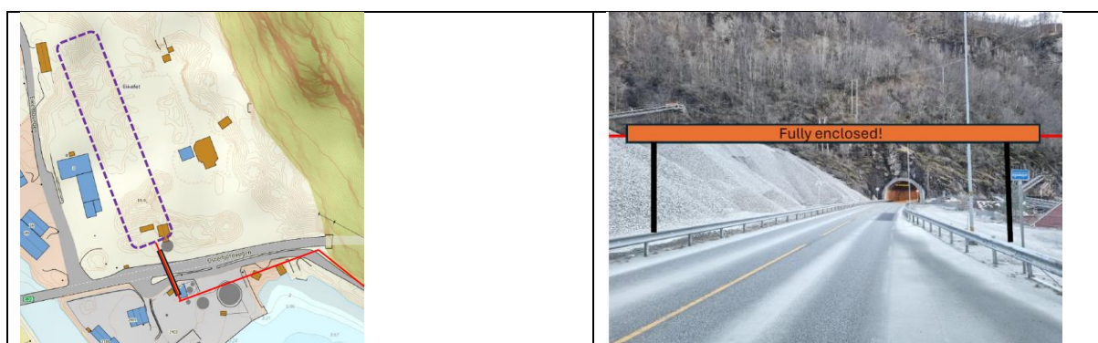
Figur 4-7 Skisse som viser korleis transportband frå prosessområdet er planlagt over eksisterende E-39. Kjelde: Eikefet Minerals AS
