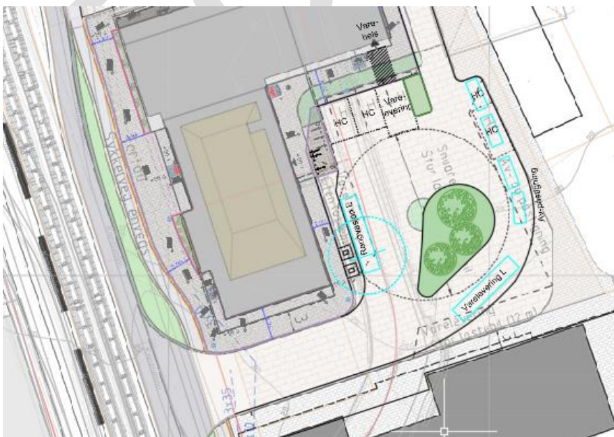
Figur 2-16 Alternativ 4 med renovasjon lagt langs byggets østfasade.
