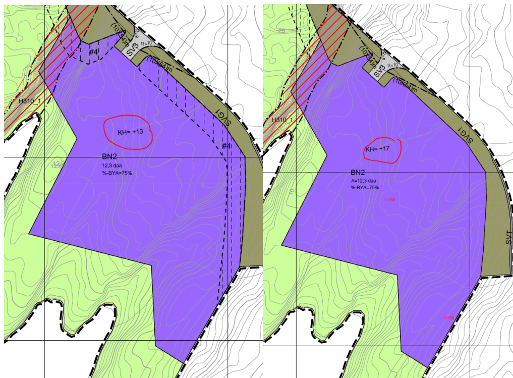
Figur 2-5 Venstre bilete : Utsnitt av gjeldande reguleringsplan av regulert næringsbygningar (BN2) med planeringshøgde KH +13. Høgre bilete : Utsnitt av forslag til planendring. Endra kotehøgde på BN2 til KH +17 (Multionsult Norge AS, 2023)
