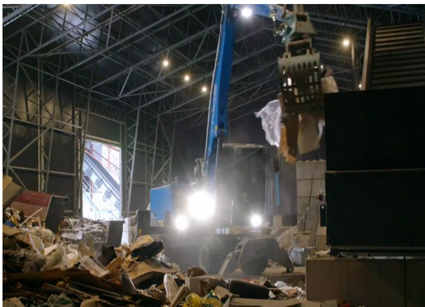
Figur 18 Bilde av gravemaskin som sorterer og legger avfall på transportbånd, Bjorstaddalen
