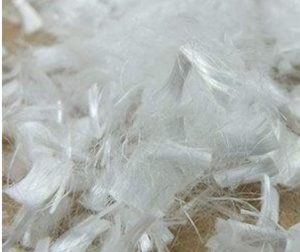
Figur 11: Polypropylen som fibermateriale i betong.
